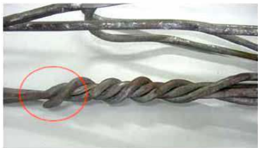
Região do Arrebetamento, observam-se fraturas dúcteis por tração
