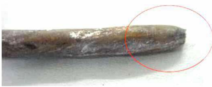
Região do Arrebetamento, observam-se fraturas dúcteis por tração
