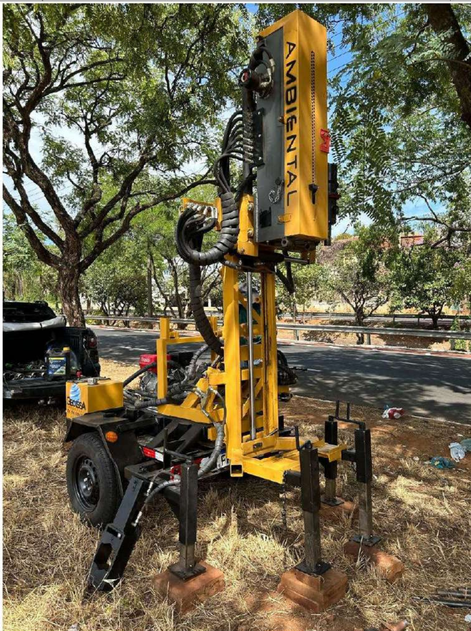
Foto Ilustrativa do equipamento utilizado Sonda Hidráulica CD100. (essa foto não corresponde a obra do serviço contratado)
