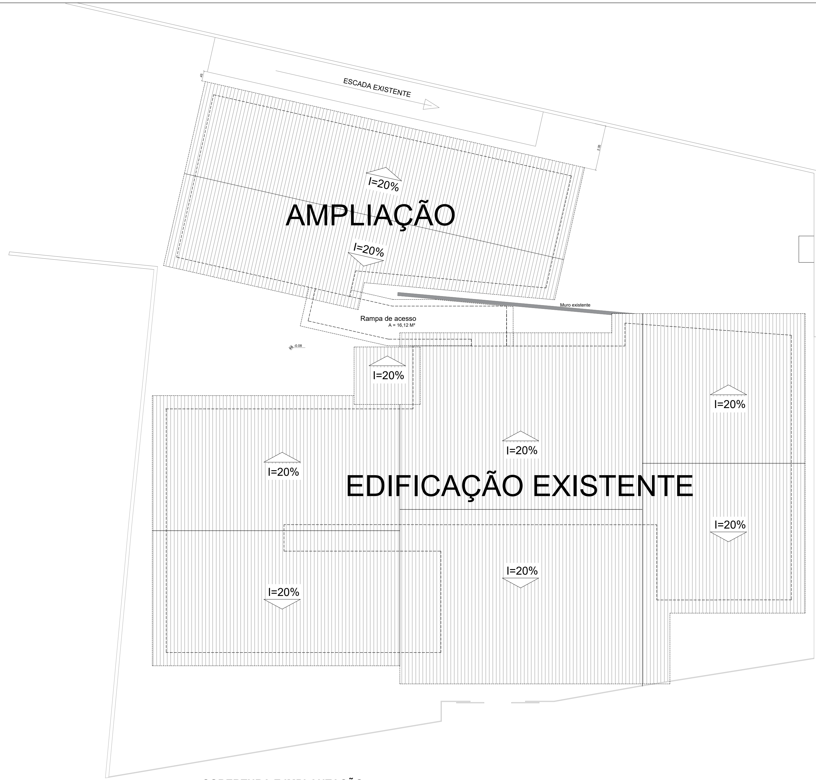
COBERTURA E IMPLANTAÇÃO ESC: 1/200
