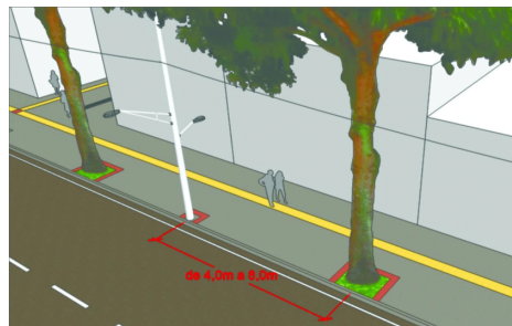
Figura 5. Distância mínima do eixo do tronco de espécies de pequena, média e grande porte dos postes. Disponível em: < https://www.researchgate.net/publication/276918890 >
