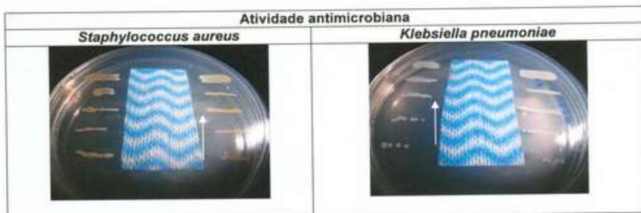
Figura 2. Fotografias dos principais resultados da avaliação da atividade antimicrobiana do item, Pano Multiuso Uso Fácil contra Staphylococcus aureus e Klebsiella pneumoniae , segundo método qualitativo da Norma AATCC 147 Test Method 147-1993. As setas indicam zonas de inibição (sem crescimento bacteriano).
