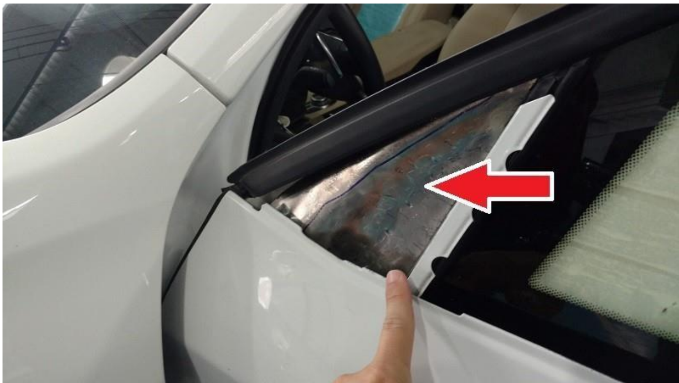
Figura 10 - Chapa de aço inox aplicada na região do retrovisor externo
