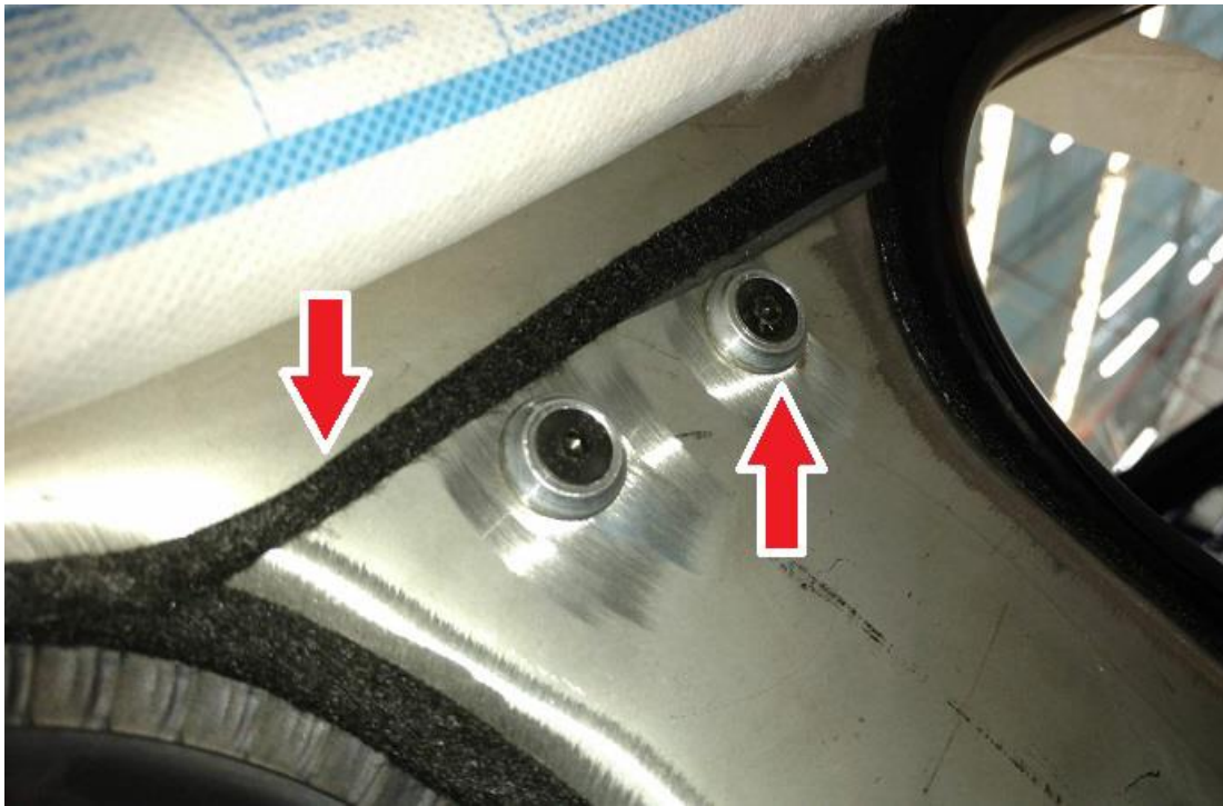
Figura 1 - Detalhe da fixação das chapas de aço inox no interior do veículo com rebites de rosca e da fita de feltro
