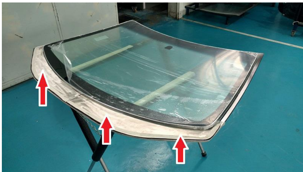
Figura 5 - Reforço em aço inox na região do offset (sorriso) do para-brisa 3.4.5. O vidro balístico deve possuir máscara serigráfica na cor preta no estilo original do vidro, obstruindo a visão do overlap da carroceria.
