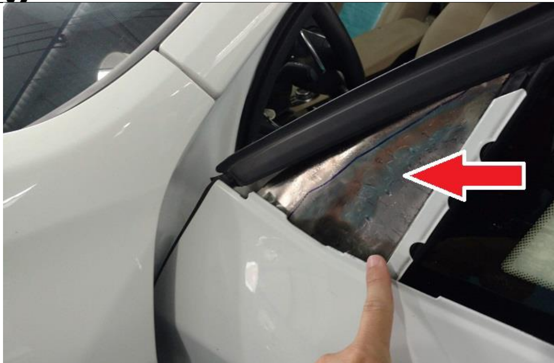
Figura 10 - Chapa de aço inox aplicada na região do retrovisor externo
