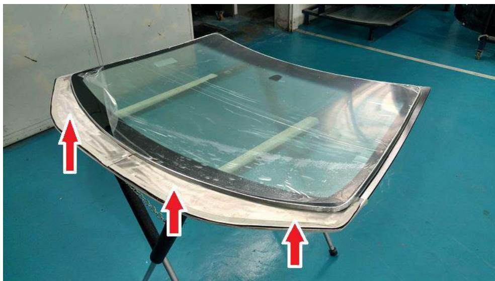
Figura 5 - Reforço em aço inox na região do offset (sorriso) do para-brisa
